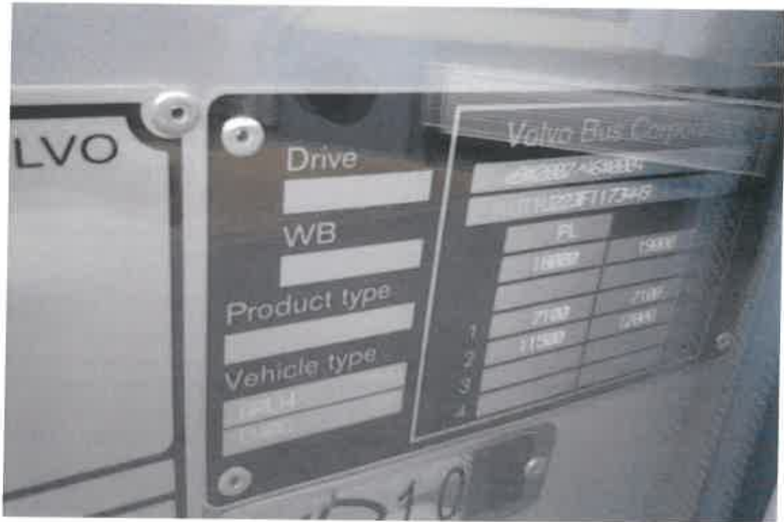
zdjęcie 3 – W tego typu autobusach VOLVO na obudowie wewnętrznej przy drzwiach wejściowych przednich zamocowana jest tabliczka znamionowa z numerem identyfikacyjnym pojazdu. W tym wypadku jest to numer VIN YV3T1U223F1173449 (tabliczka przy schodach wejściowych). Tabliczka ta zawiera także model pojazdu i inne dane techniczne.
