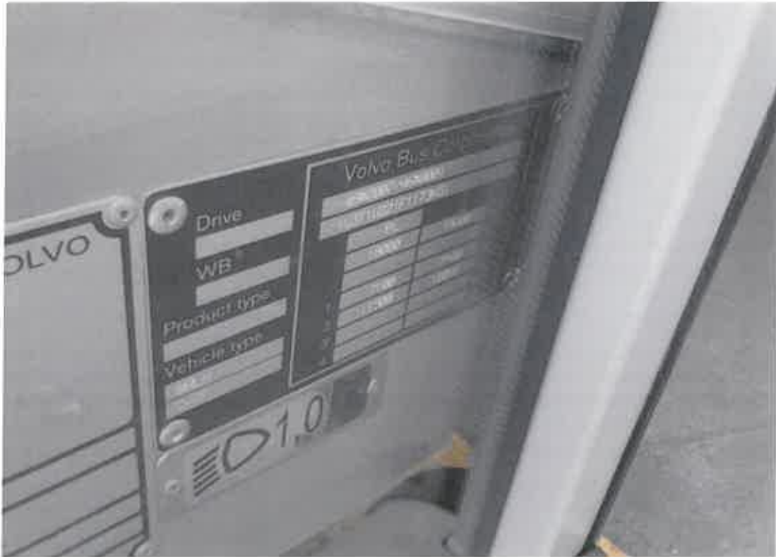
zdjęcie 21 – Na obudowie wewnętrznej przy przednich drzwiach wejściowych zamocowana jest tabliczka znamionowa z numerem VIN YV3T1U221F1173451.
