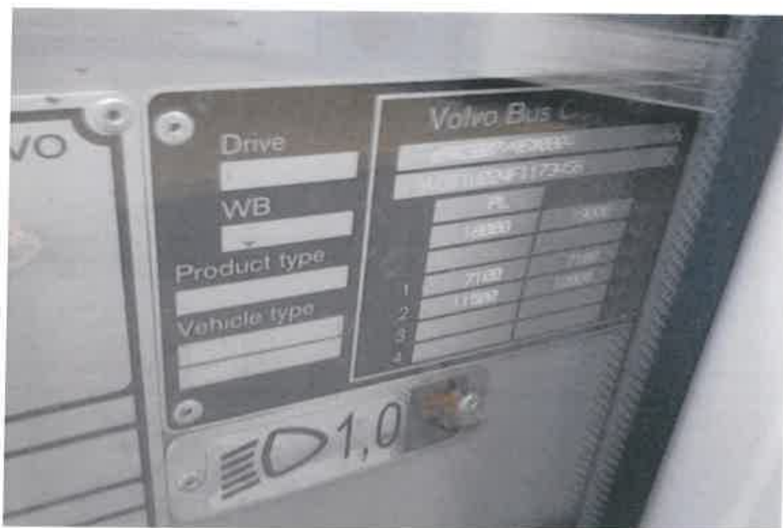
zdjęcie 11 – Widok na tabliczkę znamionową zamocowaną na wewnętrznej obudowie przy drzwiach wejściowych przednich z numerem identyfikacyjnym VIN YV3T1U224F1173458.
