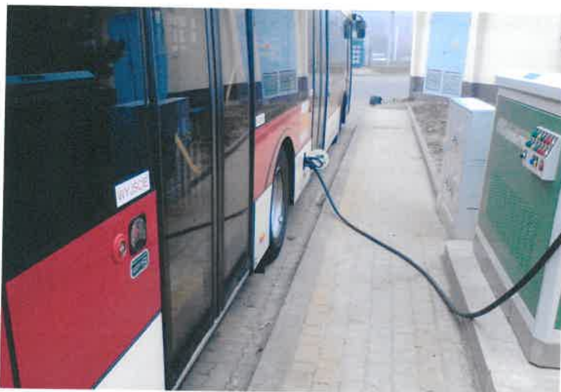
zdjęcie 28 – Opisany autobus w trakcie ładowania akumulatorów. Takie załadowanie autobusu wystarczy na jazdę po mieście w ciągu jednego dnia.
